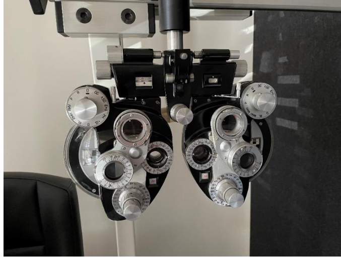
Abbildung 2: Herkömmlicher Phoropter der American Optical Corporation
