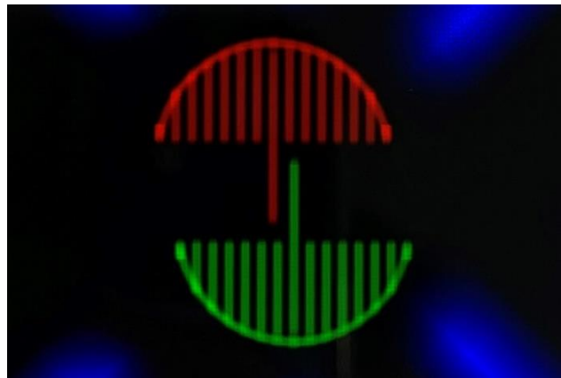
Abbildung 4: Testmuster von Netra. Die langen Linien des roten und des grünen Schirms müssen übereinander gebracht werden
