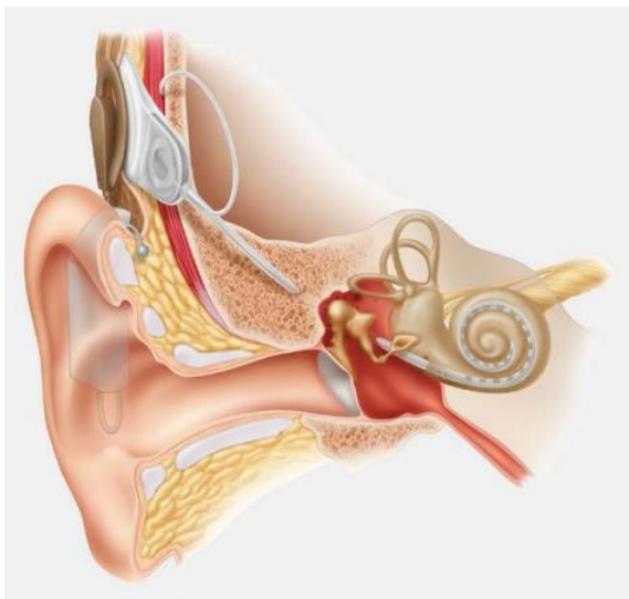
Abbildung 2: Lage eines CIs mit Spule und Elektroden im Ohr (Lenarz, 2017)
