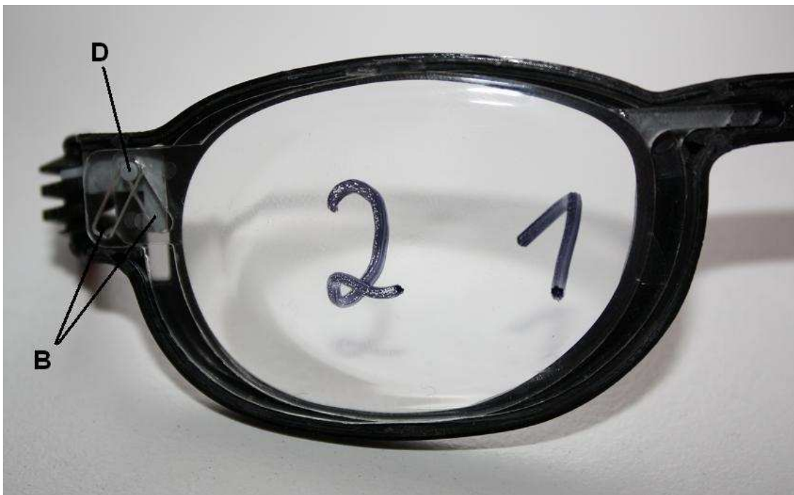
Abb. 14: Focusspec-Brille, Verschiebung der Linsen, Auslenkung oben
