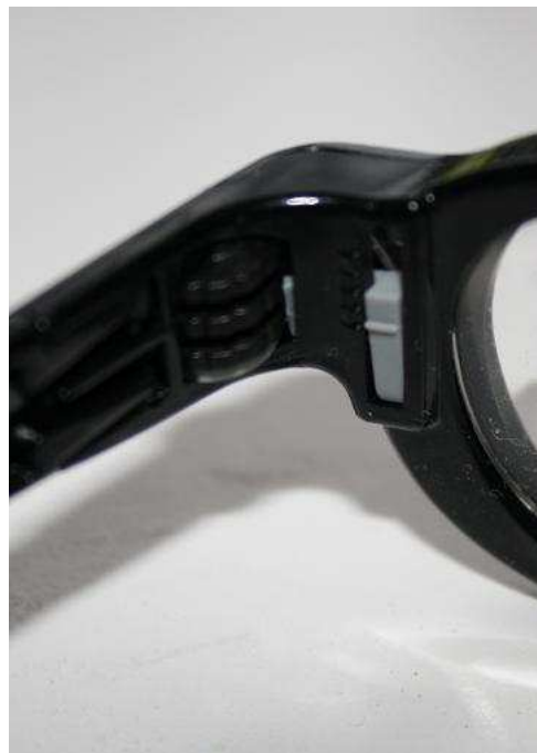
Abb. 12: Focusspec-Brille, Einstellmechanismus Auslenkung unten
