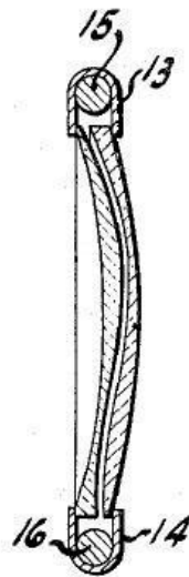
Abb. 5: Schematische Darstellung eines Brillenglasses mit Alvarez-Linsensystem, seitlich, vergrößert; [2], bearbeitet
