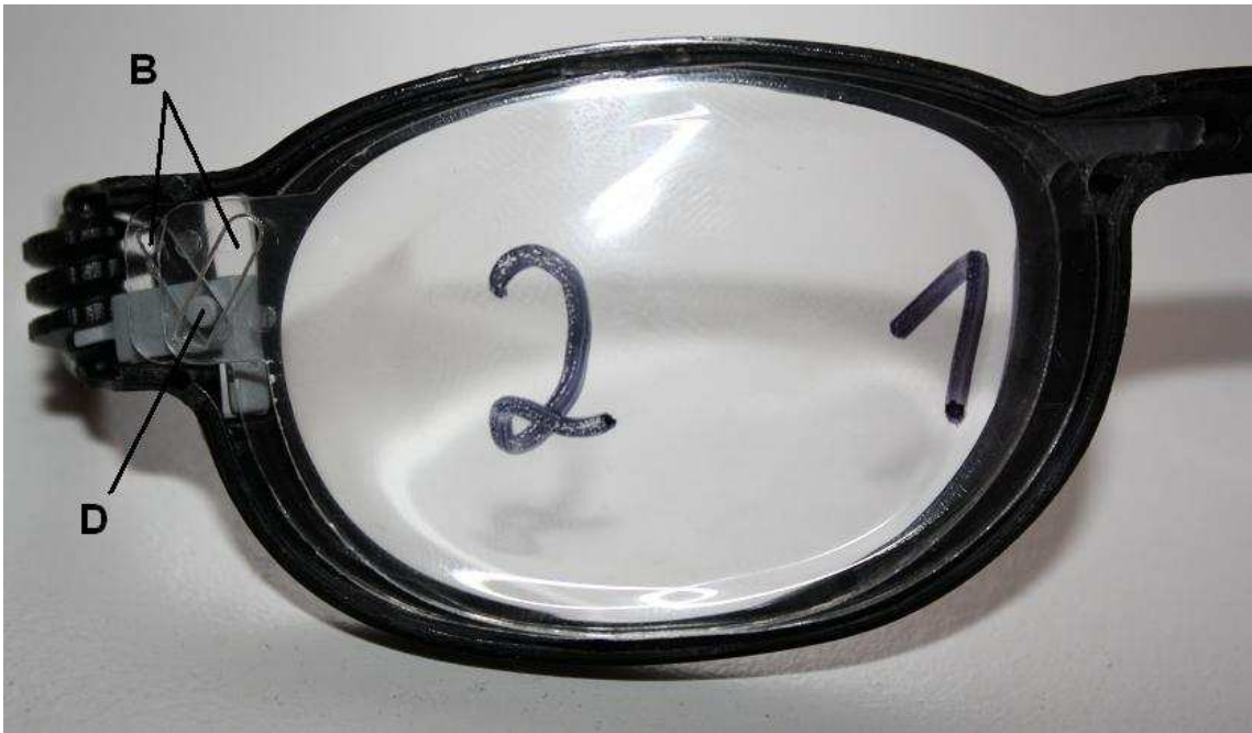
Abb. 15: Focusspec-Brille, Verschiebung der Linsen, Auslenkung unten
